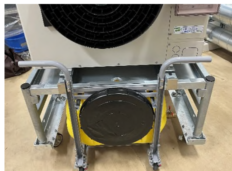
ドレンタンク台車 セット状況
