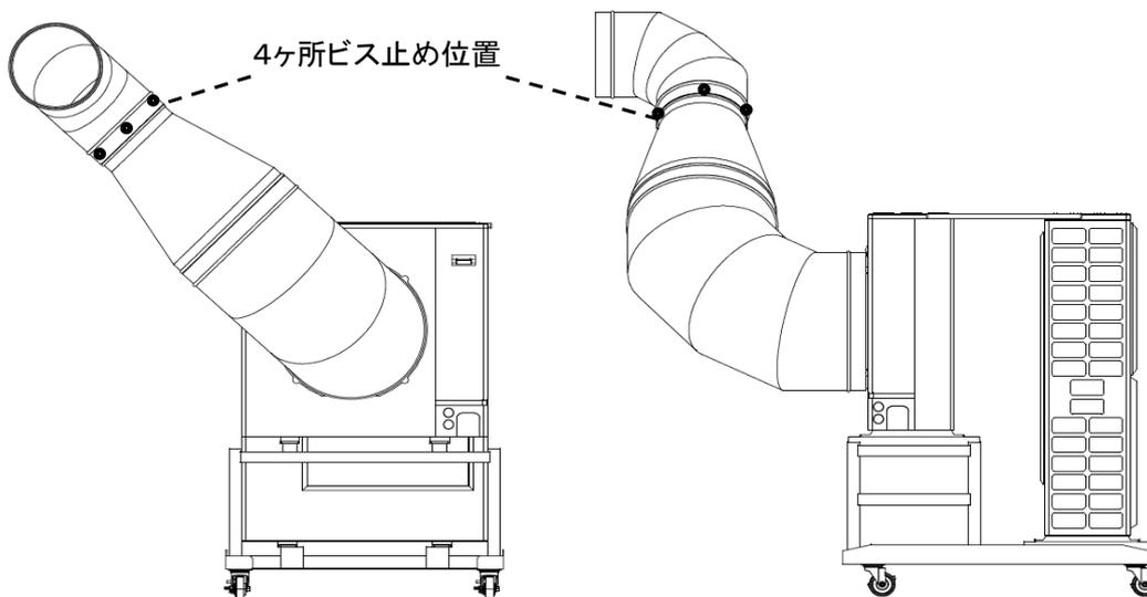
(5) 最後に各部材の接続部に、ビスの劣化防止、補強、空気漏れを塞ぐためアルミテープを巻いておいてください。
